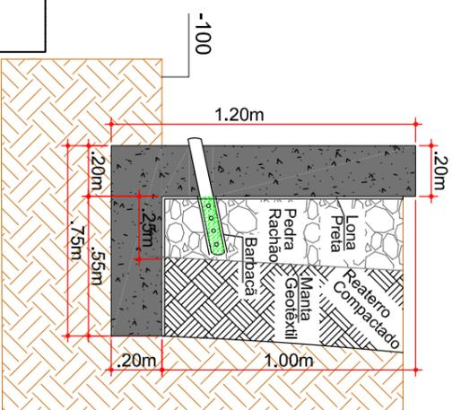
**Detalle do Muro h=1,20m**
